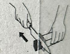
⚠ Drücken Sie das Messer nicht stark herunter. Sie benötigen kein Wasser beim Schleifen. Die durchsichtige Abdeckung stoppt bei jeder Stufe des Schleifsteins. Lassen Sie beim Schärfen das Messer an der durchsichtigen Hülle entlanggleiten. So wird der Schärfungswinkel stabilisiert und eine bessere Schärfe erreicht.
